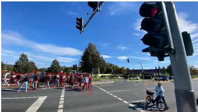
**Abb. 3 Im Projekt »KI4PED« stehen nicht die Fahrzeuge, sondern Fußgänger im Fokus. Die Personenerkennung und das Tracking wird auf Basis von LiDAR-Daten mittels KI erzielt.**
